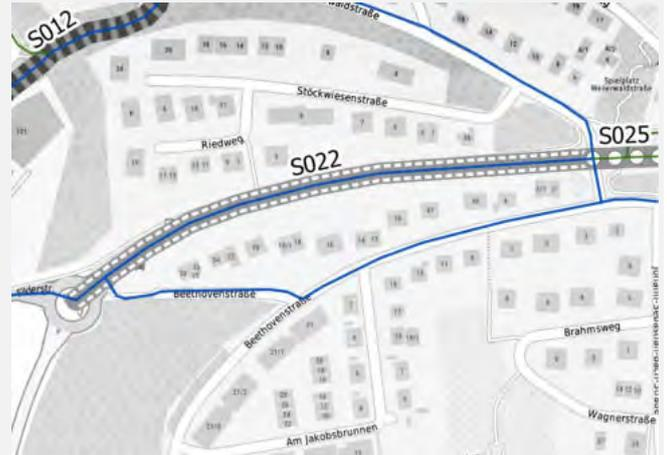
IST-Zustand: Es existieren keine Radverkehrsanlagen. Der für den Radverkehr freigegebene Gehweg besitzt eine schadhafte asphaltierte Oberfläche.
