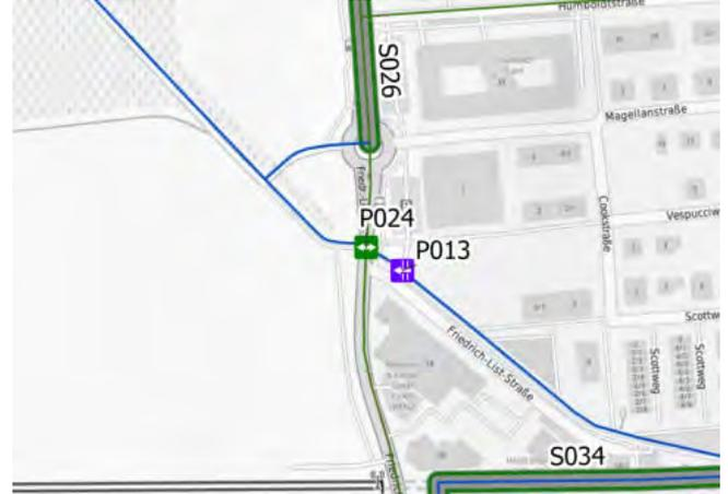
IST-Zustand: Die vorhandene Querungsisel entspricht nicht den aktuellen Regelwerken. Sie hat eine zu kurze Aufstelltiefe.
